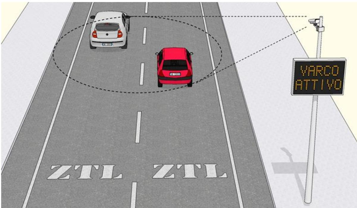
IL SISTEMA ELETTRONICO PERMETTE L'INDIVIDUAZIONE DI UNA TARGA NON INSERITA NELLA COSIDDETTA «WHITE LIST», IL VEICOLO, CON TARGA NON RICONOSCIUTA, DOPO AVER EFFETTUATO IL PASSAGGIO DAL VARCO VERRÀ INDIVIDUATO E FOTOGRAFATO CON FOTO DIGITALE AD ALTA RISOLUZIONE.
